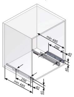
**4.-** Colocar la bandeja en el bastidor. Set the tray on the frame.
