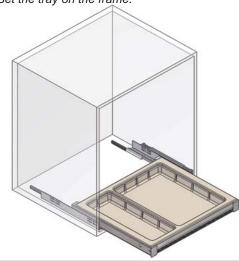
**2.-** Si el espesor de la melamina del mueble es 19mm, girar las patillas como se indica.
