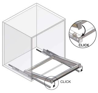
NOTA .- El desmontaje se hará presionando y tirando según dibujo.
